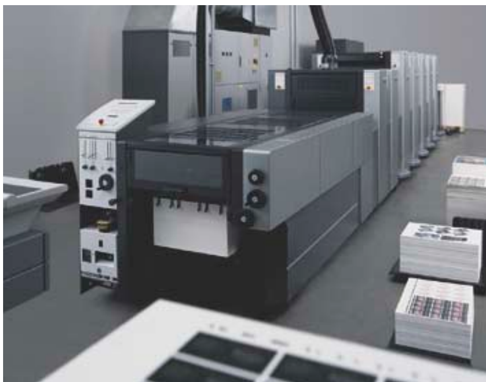
La Speedmaster SM 52 + LD, imprime, barniza y troquea en un solo paso
